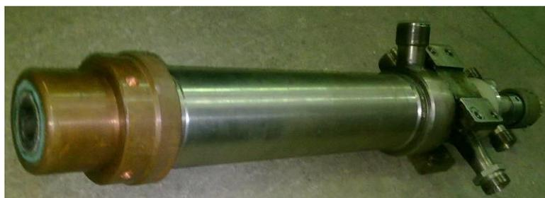
Рисунок 2.3 - Изготовленный плазматрон нового типа
