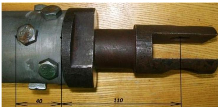
Рисунок 5.55 – Деталь приспособления для приложения нагрузки, устанавливаемая на титановый образец
