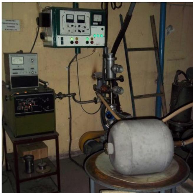
Рисунок 8.23 – Стенд проверки на герметичность лейнера
