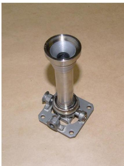
Рисунок 6.15 - Камера сгорания из сплава на основе соединения  $Ni_3Al$  с приваренным к ней образцом форсуночной головки из стали 12Х18Н10Т
