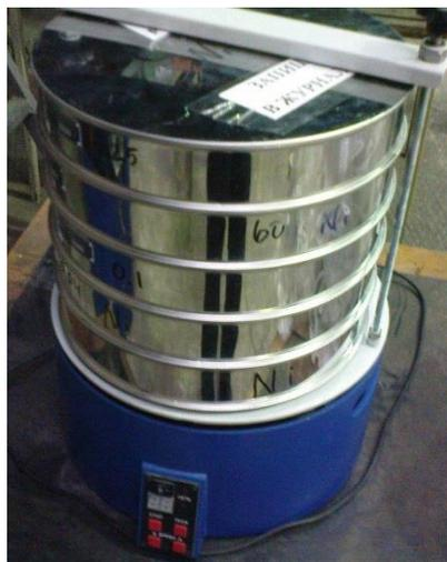
Рисунок 2.5 - Ситовый анализатор А-30 для сухого отсева на фракции в периодическом режиме
