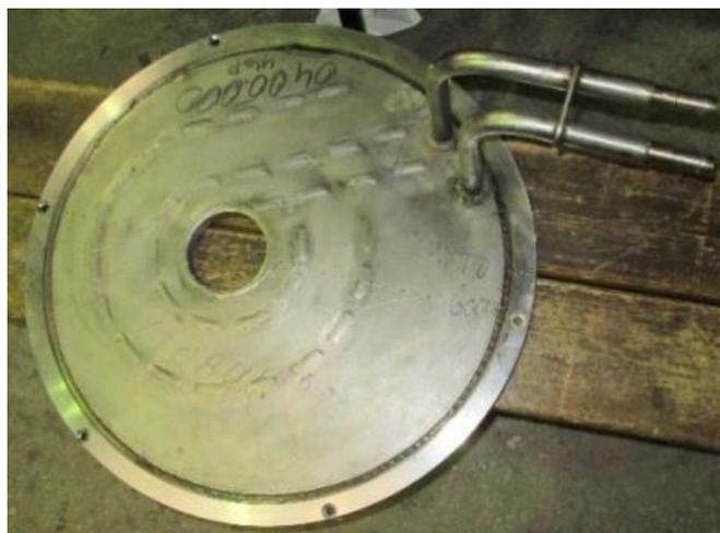
Рисунок 2.19 - Общий вид водоохлаждаемого экрана
