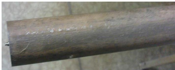
Рисунок 4.4 - Прессованный пруток диаметром 40 мм из сплава ТН-1
