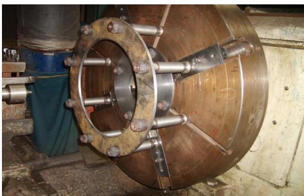
Рисунок 8.4 - опорная часть оснастки для обработки на токарном станке нижней части оболочки капсулы
