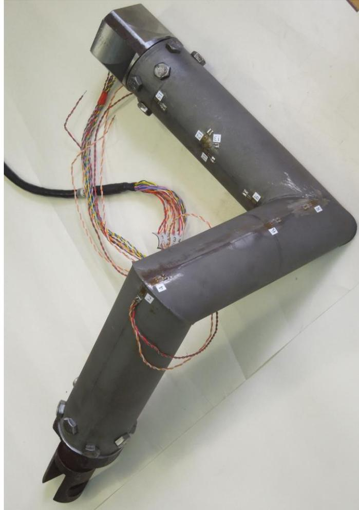
Рисунок 5.60 – Номера и расположение тензодатчиков, наклеенных на образец
