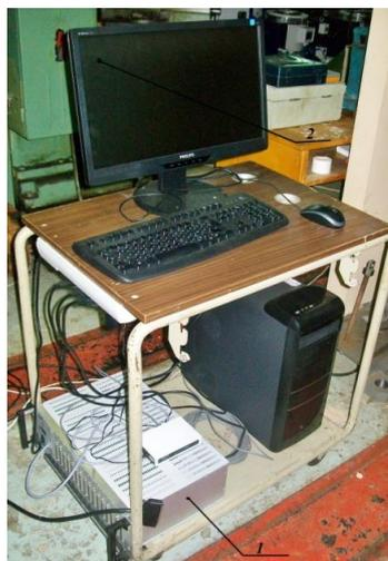
Рисунок 5.61 – Тензометрическое оборудование в сборе: 1 – СТММ, 2 – Дисплей ПЭВМ
