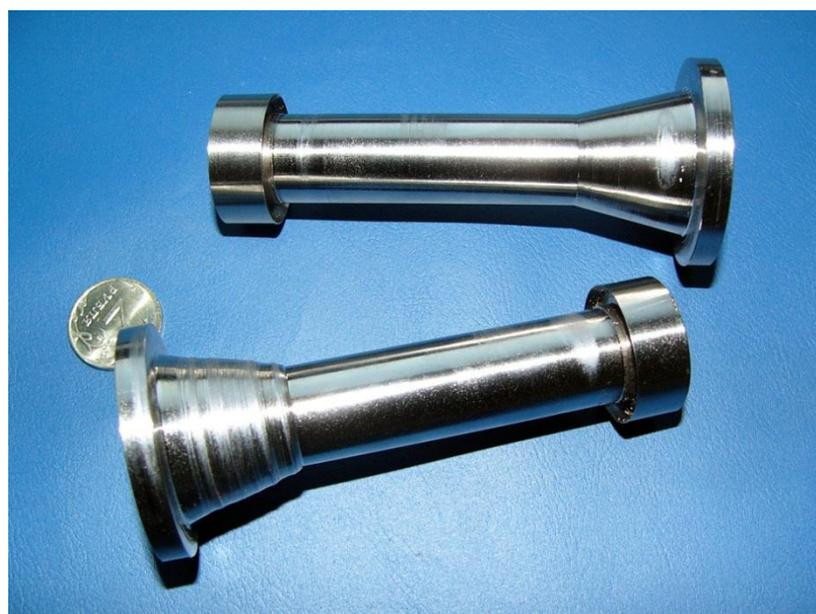
Рисунок 6.12 – Опытные детали «камеры сгорания» из сплава ИНГК5
