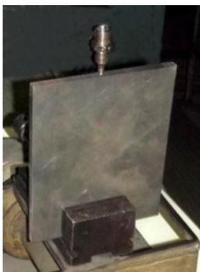
Рисунок 8.15 – Модельная капсула, имитирующая тонкостенный элемент лейнера
