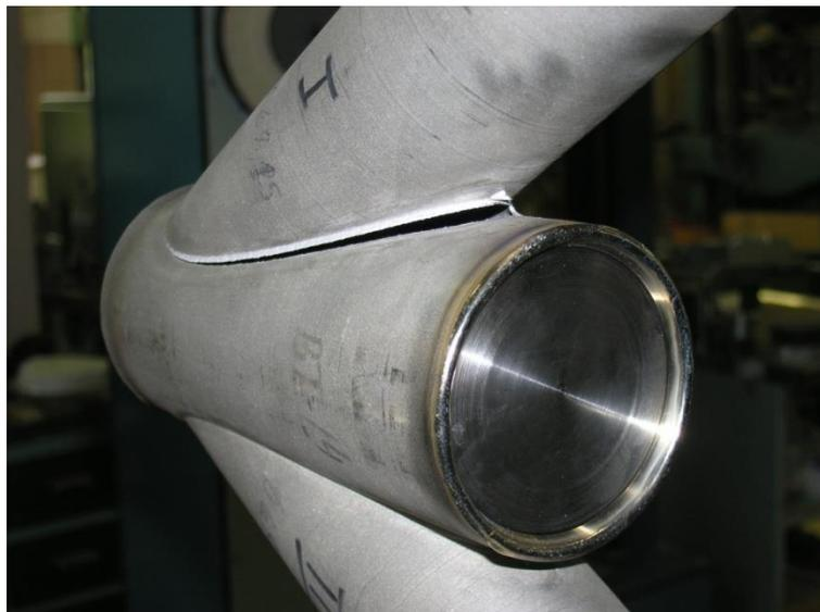
Рисунок 5.68 - Место разрушения фрагмента фермы
