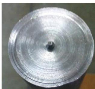
Рисунок 4.6 – Поперечный срез прутка диаметром 40 мм из сплава ТН1
