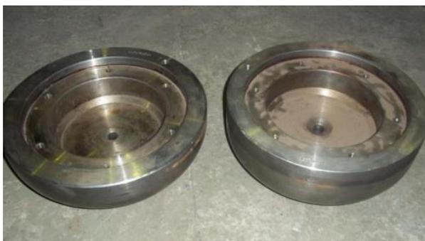
Рисунок 8.13 – Технологическая оснастка для раскатки элементов капсул
