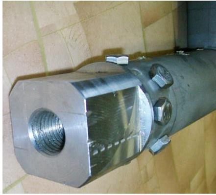
Рисунок 5.53 – Стальной вкладыш с резьбой для закрепления образца
