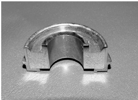
Рисунок 6.9 - Внешний вид соединения образца из сплава на основе  $Ni_3Al$  со сталью 12X18H10T, полученного аргонодуговой сваркой,  $\times 2,5$
