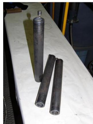
Рисунок 5.2 – Капсулы для модельных трубных элементов диаметром 30мм
