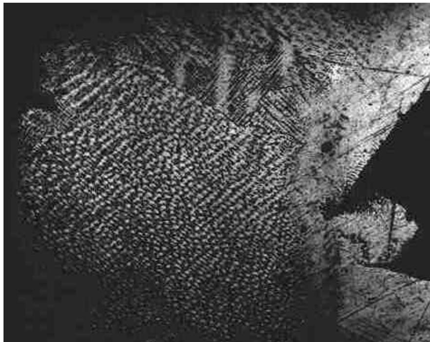
Рисунок 6.11 - Микроструктура соединения сплава  $Ni_3Al$  со сталью 12X18H10T, полученное аргонодуговой сваркой, после термообработки, х 75
