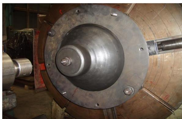
Рисунок 8.3 – фиксирующая часть оснастки для обработки на токарном станке верхней части оболочки капсулы
