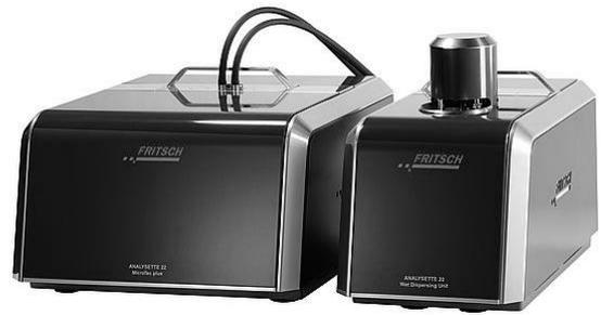
Рисунок 2.33 – общий вид дифракционного анализатора размеров частиц Analysette 22 MicroTec plus
