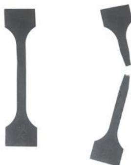
Рисунок 8.21 – Образец для механических испытаний до и после испытаний
