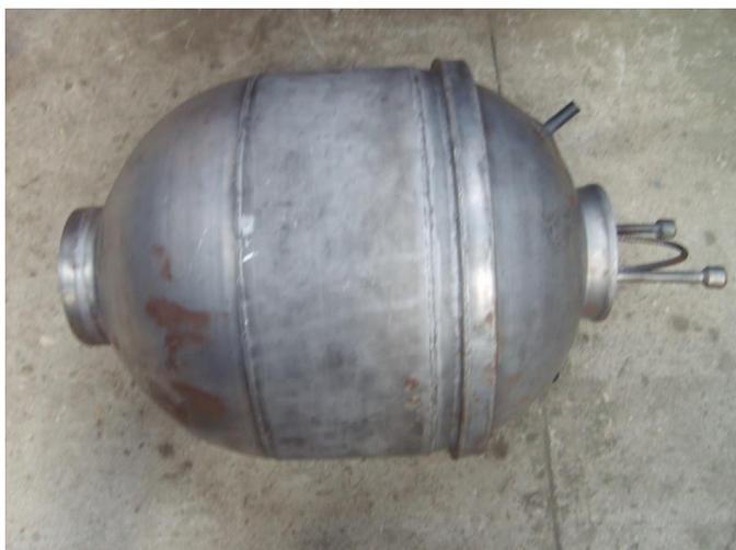
Рисунок 8.7 – Компактная заготовка бесшовного тонкостенного топливного бака
