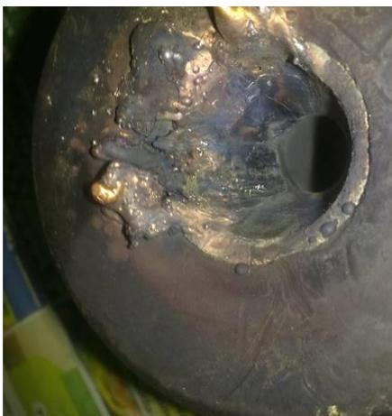
Рисунок 2.1 - Прогорание стенки водоохлаждаемого анода сопла плазматрона
