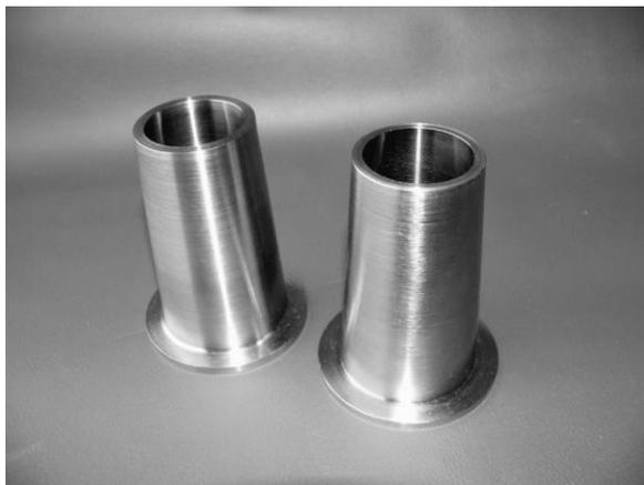
Рисунок 6.7 - Детали типа «камера сгорания» из сплава на основе соединения  $Ni_3Al$  для теплоэрозионных испытаний
