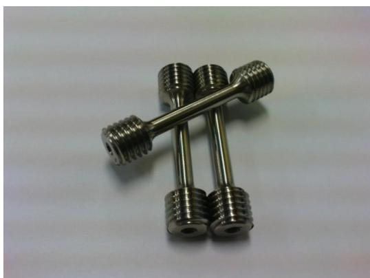
Рисунок 4.12 – Цилиндрические образцы из прутков сплава ТН-1 для определения механических свойств при растяжении
