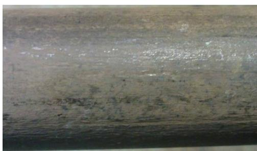
Рисунок 4.5 - Боковая поверхность прутка диаметром 40 мм из сплава ТН1
