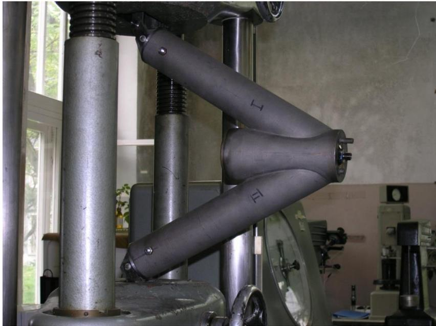
Рисунок 5.67 - Установка с объектом (фрагментом фермы) для испытаний
