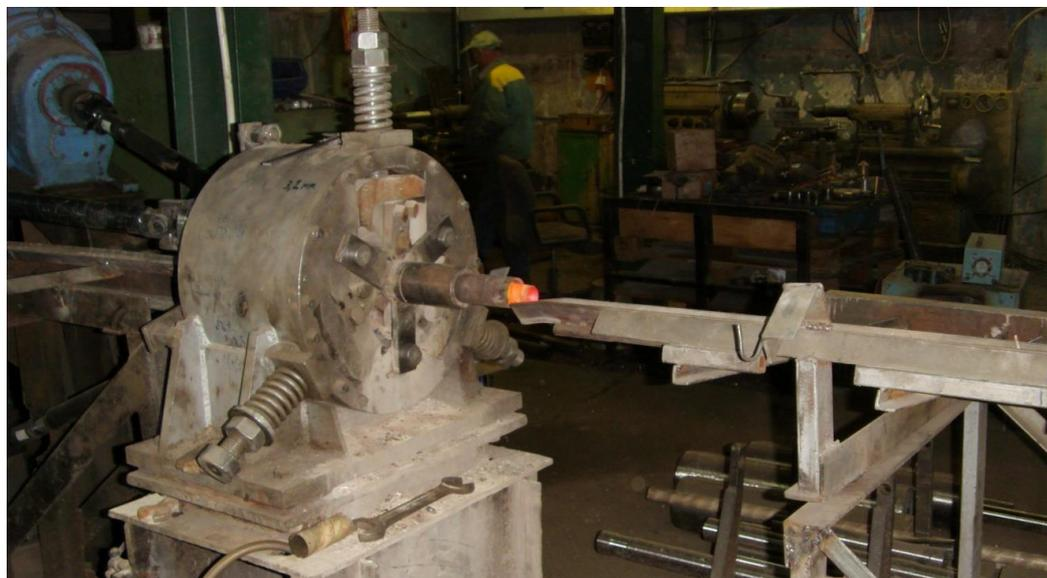
Рисунок 4.9 – Внешний вид трёхвалкового стана винтовой прокатки «14-40»
