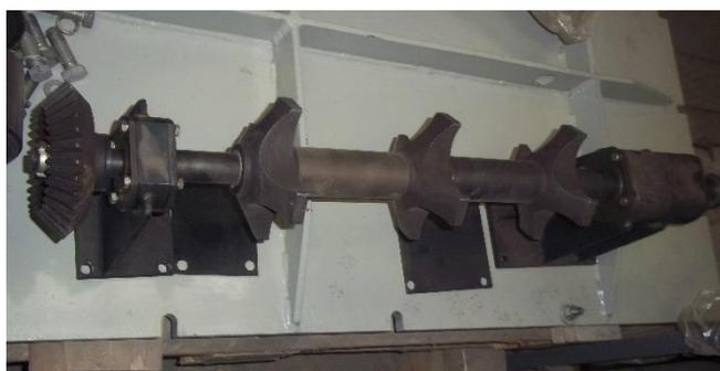
Рисунок 2.22 - Общий вид модернизированного узла подачи электродов
