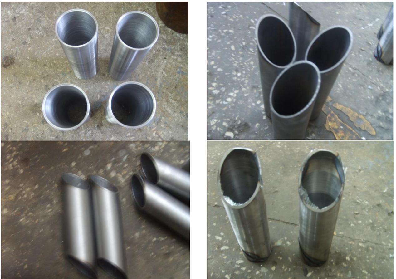
Рисунок 5.13 - Концентрические трубы с расчетноориентированными торцевыми плоскостями (элементы технологической оснастки)
