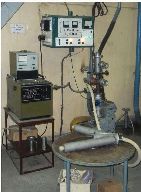
Рисунок 5.27 - Оснастка для проведения контрольных испытаний на герметичность в сборе
