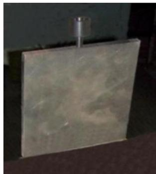
Рисунок 8.19 – Капсула для изготовления тонких образцов
