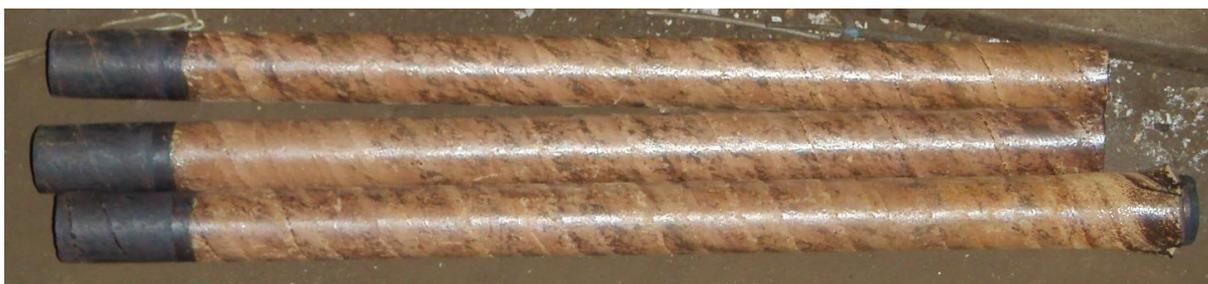
Рисунок 4.10 - Внешний вид прокатанных прутков Ø32 мм из сплава ТН-1
