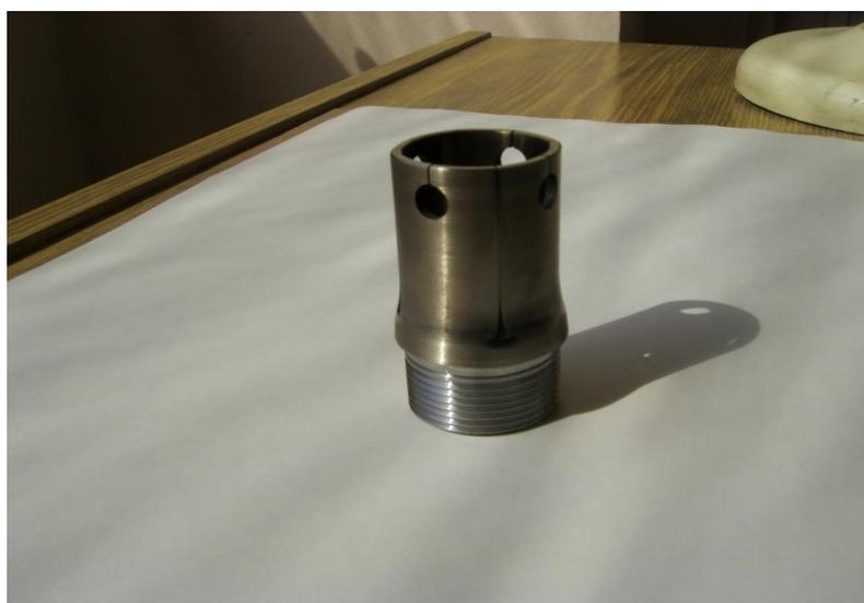
Рисунок 4.15 - Вид втулки после обжатия
