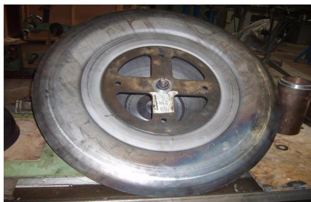
Рисунок 8.5 - фиксирующая часть оснастки для обработки на токарном станке нижней части оболочки капсулы
