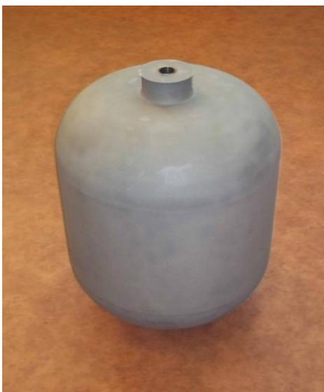
Рисунок 8.22 – Образец бесшовного гранульного лейнера
