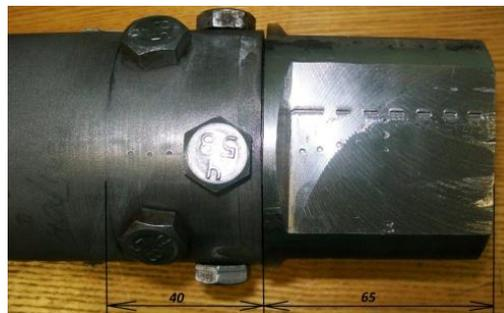
Рисунок 5.54 – Приспособление для закрепления образца в четырехкулачковом патроне
