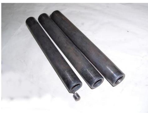
Рисунок 5.3 – Компактные заготовки модельных трубных элементов в капсуле
