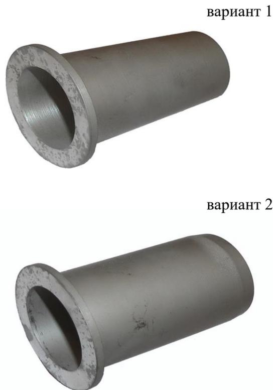
Рисунок 6.17 - Модели конической (вариант 1) и цилиндрической (вариант 2) камер сгорания из  $Ni_3Al$  до испытаний
