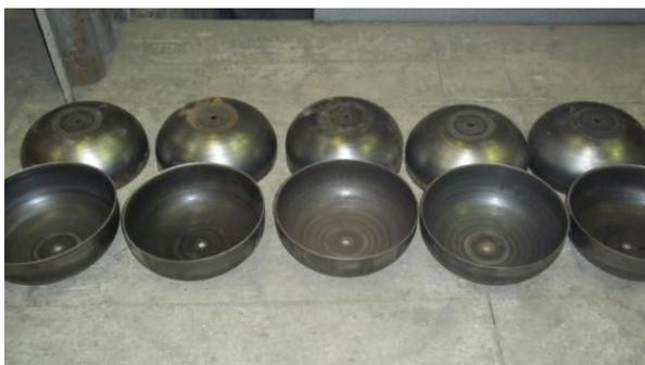
Рисунок 8.14 – Заготовки под внутренний и внешний элементы капсул
