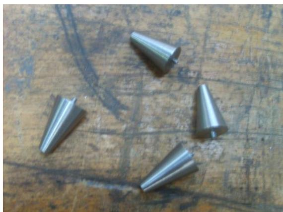
Рисунок 5.16- Конические пробки (элементы технологической оснастки)
