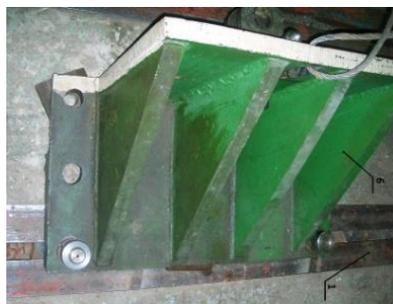
Рисунок 5.57 – Крепление системы нагружения к силовому полу
