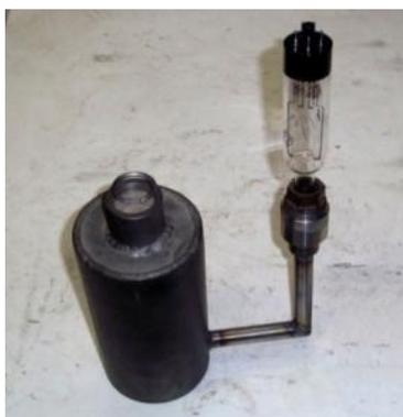
Рисунок 8.16 – Модельная капсула (Ø 90x200) мм, засыпанная гранулами ВТ6, с преобразователем ПМТ-2
