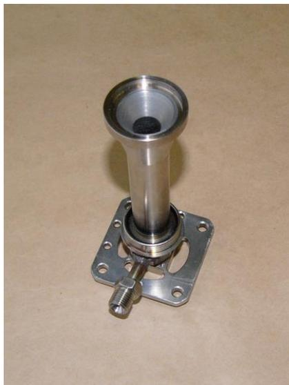
Рисунок 6.14 - Камера сгорания из сплава на основе соединения  $Ni_3Al$  с приваренным к ней образцом форсуночной головки из стали 12Х18Н10Т
