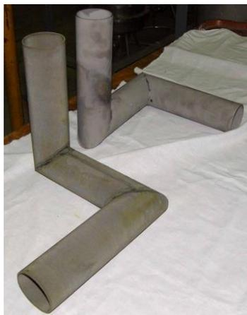
Рисунок 5.19 – Внешний вид тонкостенных трубных элементов после удаления стальной капсулы методом химического травления
