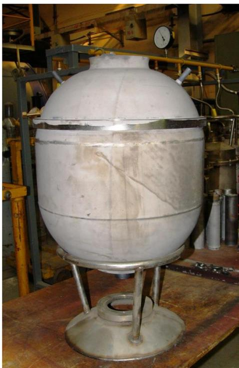
Рисунок 8.8 – Компактная заготовка бесшовного топливного бака из гранулированного титанового сплава ВТ23
