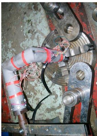
Рисунок 5.56 – Образец с установленными на нем приспособлениями, закрепленный на силовом полу лаборатории
