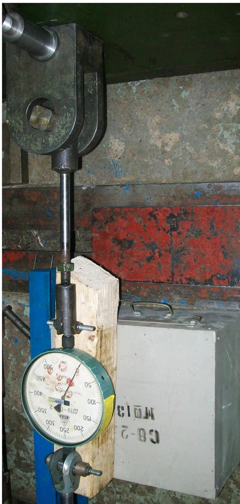
Рисунок 5.59 – Закрепление динамометров при испытаниях
