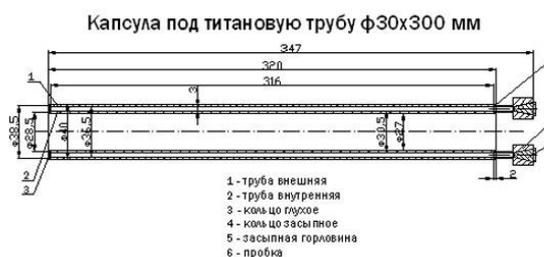
Рисунок 5.1 – Эскиз капсулы для модельных трубных элементов диаметром 30мм
