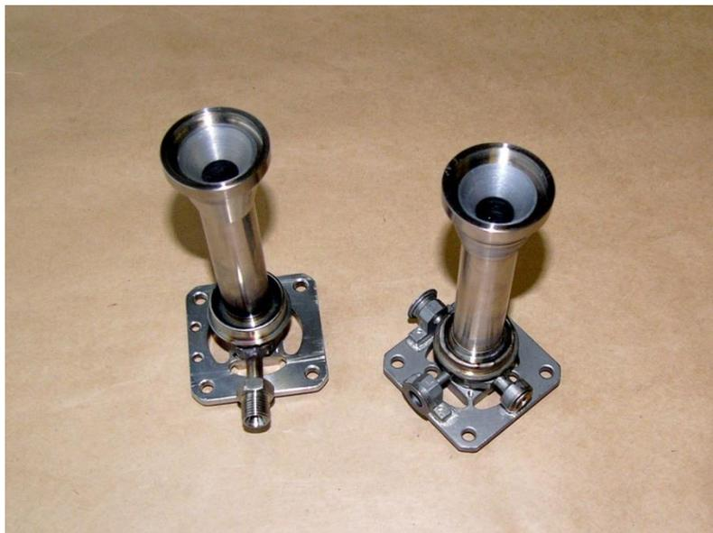
Рисунок 6.13 - Камеры сгорания из сплава на основе соединения  $Ni_3Al$  с приваренным к ней образцами форсуночной головки из стали 12X18H10T
