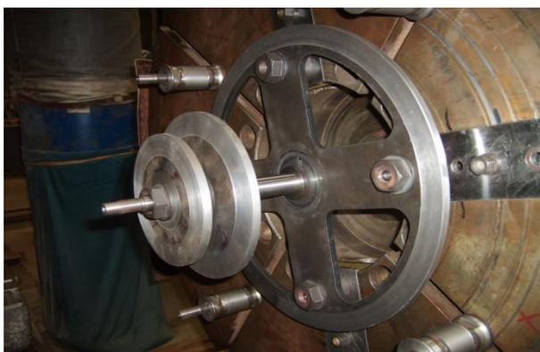
Рисунок 8.2 – опорная часть оснастки для обработки на токарном станке верхней части оболочки капсулы
